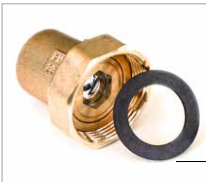
UNIVENTA Kugelabsperung aus Messing, 1" Innen Gewinde und 6/4" Überwurfmutter einschließlich Flachdichtung geeignet zum direkten An- schluss an den Univenta Kunststoffverteiler.
